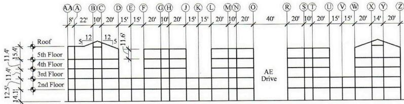
Figura 5. Sezione del Pentagono. Altezze piani: 4,30 m; 3,81 m; 3,47 m, 3,47 m, 4,69 m, 1,52 m. Altezza totale: 19,7 m (facciata); 21,26 m (colmo). Le misure nel disegno sono espresse in piedi (1 piede = 30,5 cm). Fonte: Pentagon Building Performance Report.
